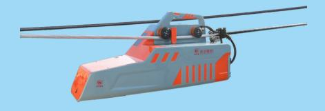
智能涂覆机器人主要应用于 10kV/35kV 裸导线的带电绝缘涂覆项目。随着我国城市化的不断推进,越来越多的老旧高压裸导线深入到居民的生活空间,因此,造成了极大的触电安全隐患,为了有效杜绝居民区触电事故的发生,国家电网、南方电网大力推行高压裸导线的绝缘工程。
